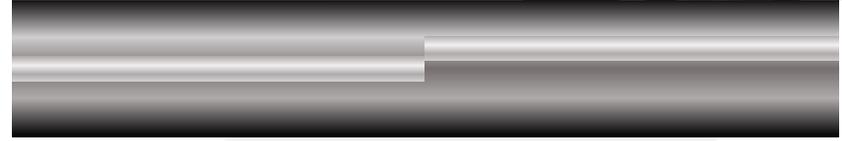
4. Espacio de aire: la fibra no se inserta completamente en el empalme / adaptador.
